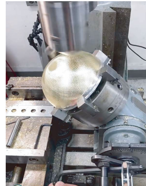
• 反射模具器加工过程
